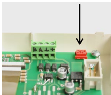
Коннектор на плате дисплея
